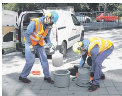
Metoda sledování vývoje epidemie covidu-19 je založena na tom, že většina nakažených masivně vylučuje zbytky viru ve stolici a virová RNA se tak dostává do odpadních vod. Do kanalizace u školy je umístěno speciální zařízení, které odebírá vzorky.
